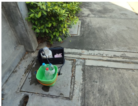
ภาพที่ 10-9 ฝาบ่อตรวจคุณภาพน้ำทั้งเป็นฝาคอนกรีต และเก็บตัวอย่างตรวจสอบคุณภาพน้ำทั้งด้วยวิธี Grab Sampling ทุกเดือน
